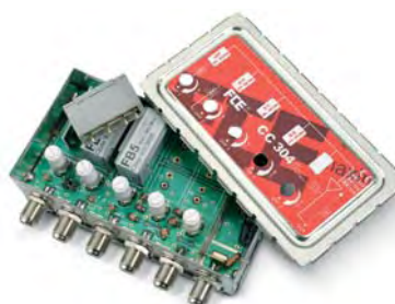
Detalle configuración de filtros
